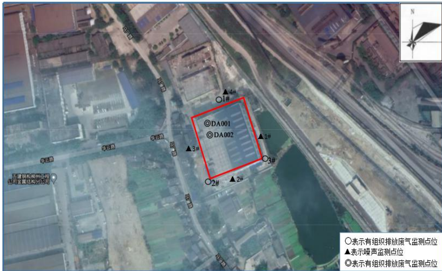
附图 2 平面布置及废气、厂界噪声监测点位图
